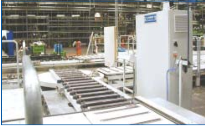
Motor kommer från kylzon och går till montage eller reparation eller vändning 180°.
