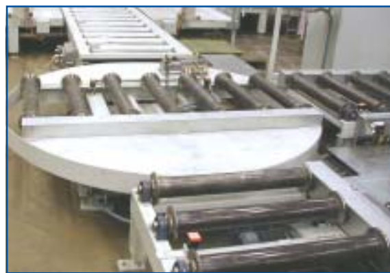
Reverserande virdbord med transport i tre riktningar via mekaniskt stopp.
