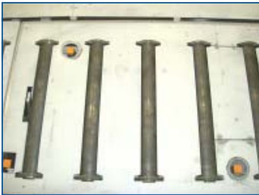
64 st buffertplatser med 3 st säkerhetsgivare så att motorer ej kan krocka med varandra.
