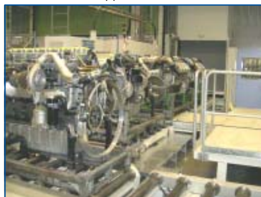
Motorer kommer ut från kylzonssluss. Sluss har 4 st snabbgående dörrar för att minimera ljudnivå.
