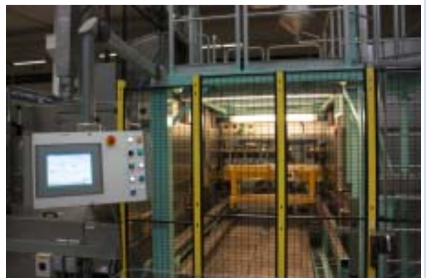
Helautomatisk transportvagn med dubbla inmatningspushrar som tar in och ut pallett (bild ovan och nedan).
