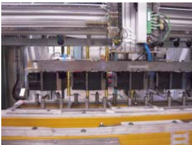
Linjeportal lastar åkvagn med 5 st cylinderhuvuden och lastar av 5 st cylinderhuvuden vid samma tillfälle.
