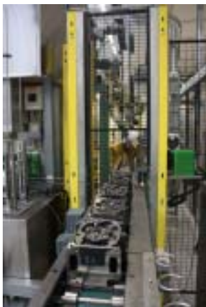
Automatisk buffertering av 5 st cylinderhuvuden före linjeportal.
