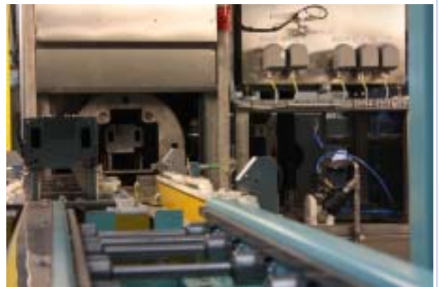
Helautomatisk transportvagn med dubbla inmatningspushrar som tar in och ut pallett (bild ovan och nedan).
