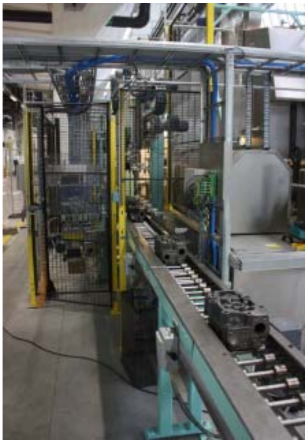
Buffererande intransportbana med härdade rullar och linjeportal som lastar 5 st cylinderhuvuden i taget.
